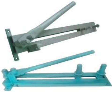
Máquina Estribos nº1 / nº2 / Reforçada
